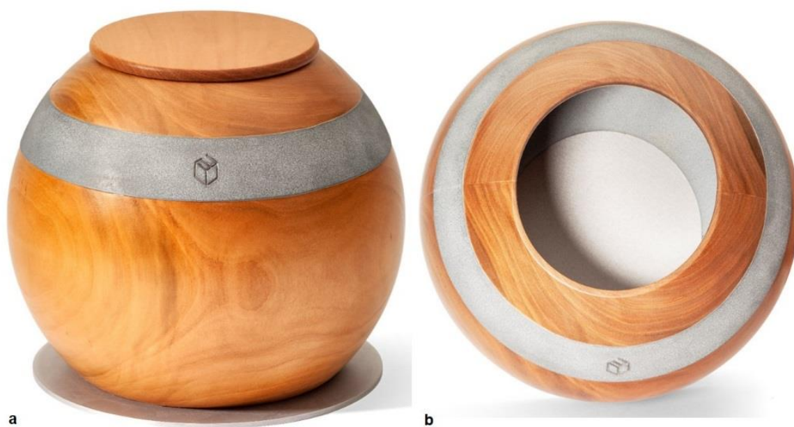
Fig.1 : Fumoir « Kapnos » en merisier après projection d'alliage Zn-Al, en cerclage extérieur de la sphère et en revêtement de paroi interne jusqu'à mi-hauteur. Diamètre extérieur du fumoir : 25 cm.
