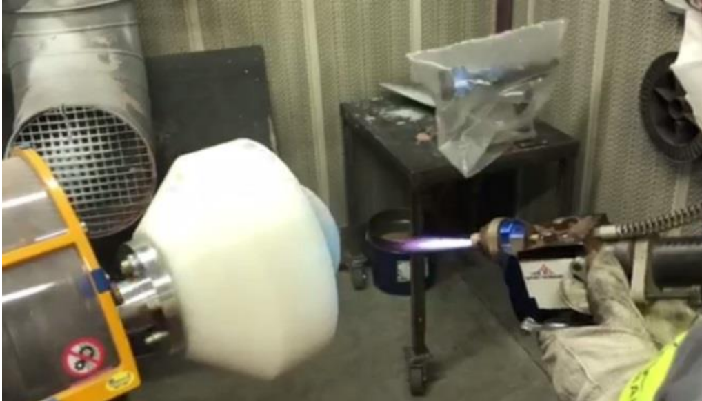
Fig. 8 : Dispositif expérimental pour la projection sur le fumoir « Kapnos » enserré dans un montage adapté, sur tour mécanique (installation Saint-Gobain CS).
