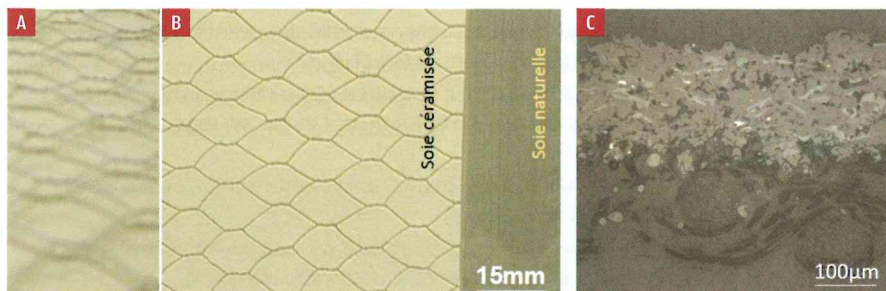
FIGURE 15 : Dépôt d'hydroxyapatite sur soie de haute couture, a) Grille pochoir en perspective, b) Vue de dessus du dépôt, c) Image optique de la couche céramique sur la soie.
