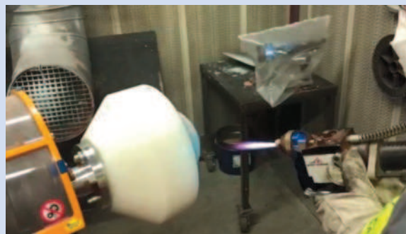
FIGURE 8 : Dispositif expérimental pour la projection sur le fumoir « Kapnos » enserré dans un montage adapté, sur tour mécanique.
