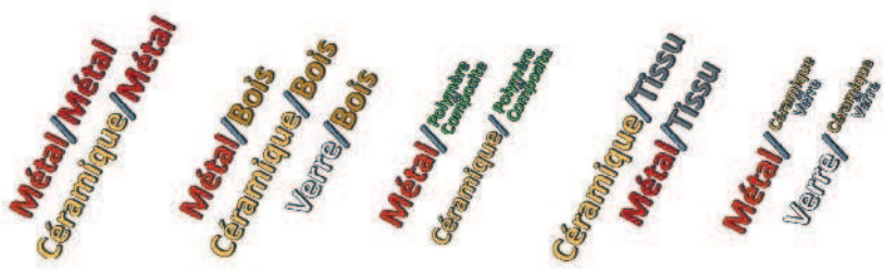
FIGURE 5 : Principaux systèmes de matériaux susceptibles d'être employés en projection thermique (notation : Matériau de dépôt/Matériau substrat).
